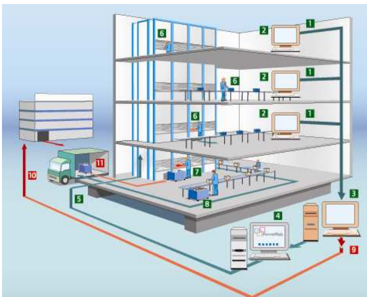
Obr. č. 2. Několikaúrovňový skladovací systém s max. výškou 30 m a max. šířkou 3,58 m vybavený nadúrovňovým řídicím SW systémem
