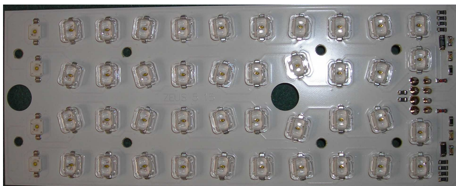
Obr. 1 – Vyobrazení modulu svítidla se světelnými diodami
