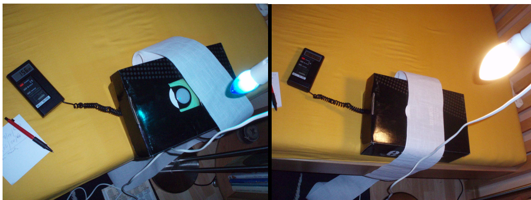
Obrázok 2 : Meranie prestupu umelého svetla cez prvok vertikálnej žalúzie luxmetrom
