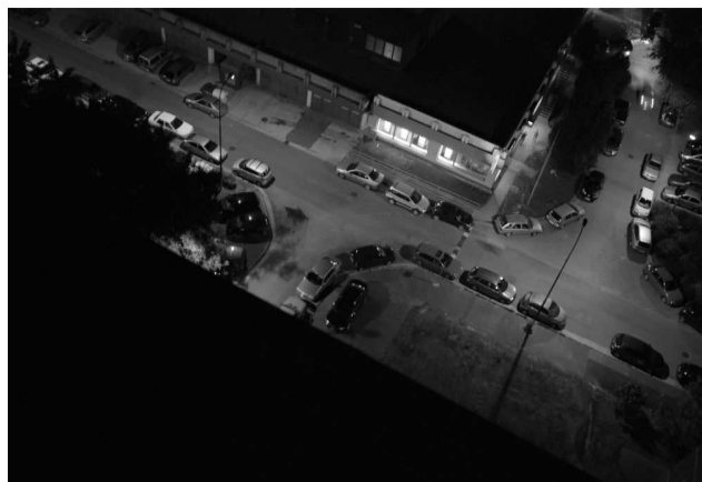
• obrázok 3 Karosérie automobilov pod pouličným osvetlením odrážajú svetlo do horného polpriestoru
